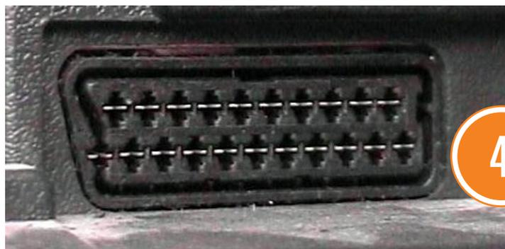
Infine, se neanche l'ingresso video composito è presente, dovrete usare un componente aggiuntivo. Potete acquistare per pochi euro in un negozio di elettronica un adattatore RCA/Scart come quello in figura. Posizionate l'interruttore su "Input", collegate all'adattatore i tre spinotti del cavo visto al passo precedente, e inserite l'adattatore nella presa Scart del televisore.
